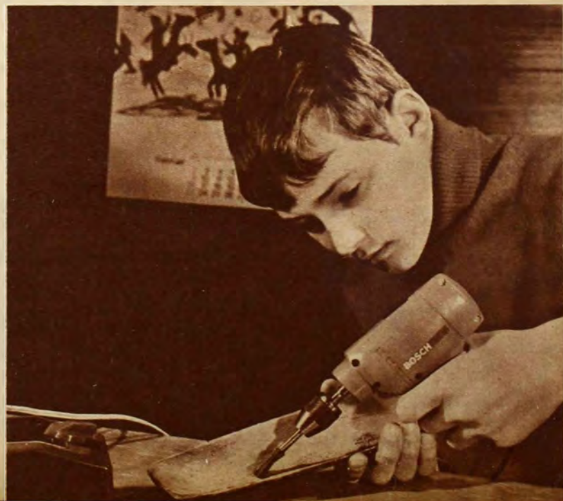
Az átlátszó oldalon át működésben is megismerhető a villanymotor
